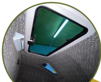
Szyberdach Hollandia H 100 o wymiarach 748 mm x 378 mm
